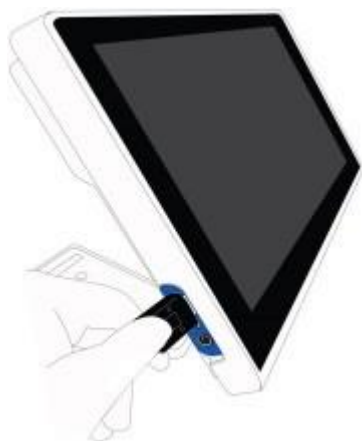
Rys. Podłączanie przewodu USB do Compact 8
