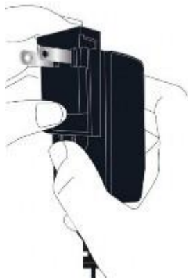
Rys. Sposób umieszczania przejściówki w zasilaczu
